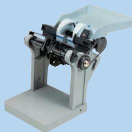
● При использовании LF-200H совместно с формовщиками аксиальных компонентов LF-200, 201 и 200T возможна последовательная формовка и резка индивидуальных компонентов длиной макс. 98 мм, мин. 62 мм. ● Простая центровка в барабане.
