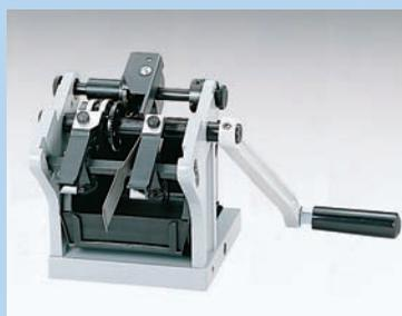
Возможно автоматизировать процесс подключением внешнего электропривода (LF-200M)
