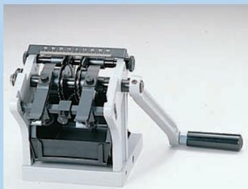
Добавив опциональную деталь, вы сможете дополнительно выполнять обрезку ножек с одной или с двух сторон.
