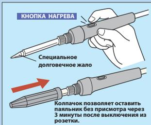
● Два режима нагревания. ● Нажатие кнопки включает форсированный нагрев (200 Вт). ● Эргономичная рукоятка из термостойкого полимера обеспечивает комфортную работу.
