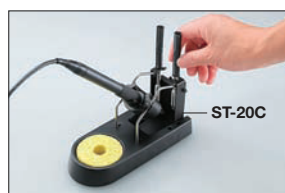
Подставка для жала ST-20C крепится на подставку для паяльника ST-20
